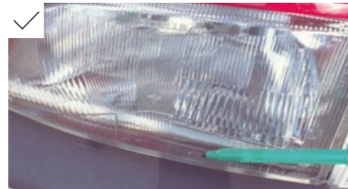
Streuscheibe mit geringfügiger Absplitterung ist akzeptabel, falls es sich nicht negativ auf das Erscheinungsbild des Fahrzeuges oder den Wirkungsgrad der Leuchte auswirkt
