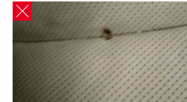
Brandlöcher in der Verkleidung, den Sitzbezügen, dem Dachhimmel und dem Bodenbelag
