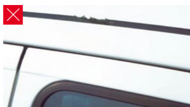
Abrieb an der Gummileiste, der sich negativ auf das Erscheinungsbild des Teils auswirkt
