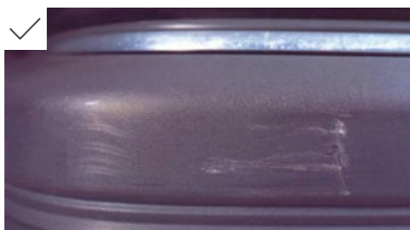
Leichter Abrieb bei nicht lackiertem Stoßfänger (oder nicht lackierter Schutzleiste), vorausgesetzt, er kann durch normale Reparatur oder Überholung ohne Austausch behoben werden
