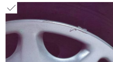
Geringfügige Schrammen mit einer Länge von weniger als 80mm sowie leichte Beschädigung oder leichter Abrieb an Felge/Radzierblende, bei nur einem Schaden pro Rad
