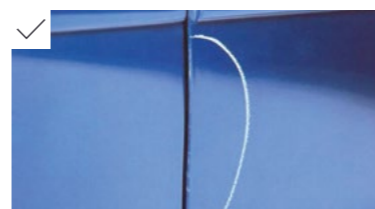
Geringfügige Lackabsplitterungen an den vorderen Türkanten, die als normale Abnutzung betrachtet werden können
